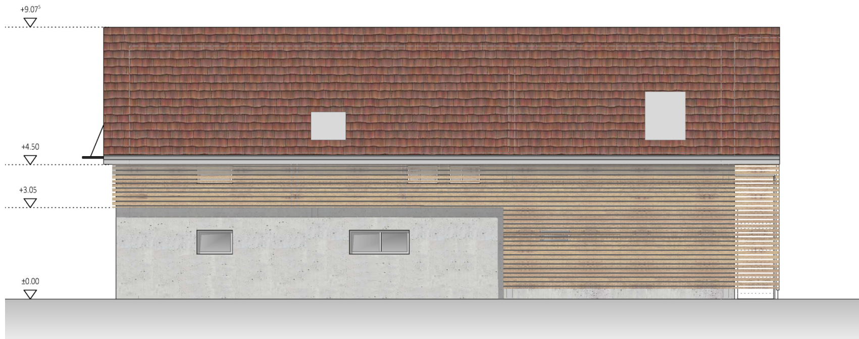
Nordansicht in Sichtbeton
