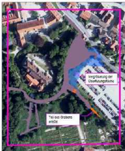
Abbildung 24: Vergleich der Überschwemmungsgebiete HQ100 für den Istzustand mit dem Planzustand (in der Abbildung: magenta) keine Flächenänderung (blau), neue Überflutung (blau), Fläche (blau) (rot) (rot)
